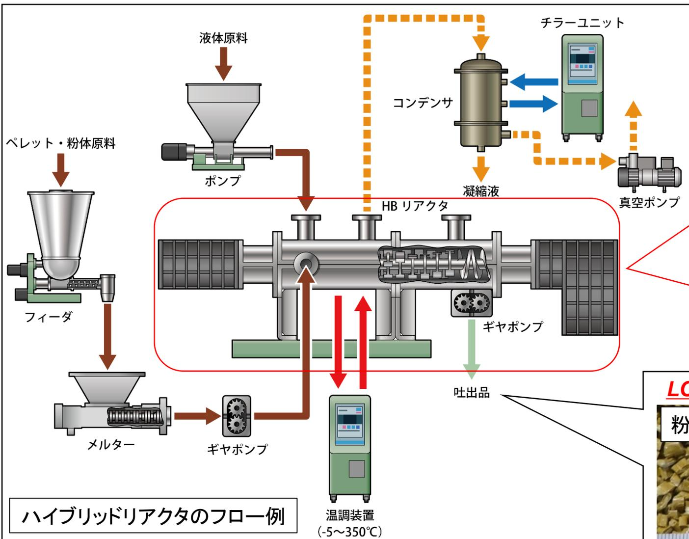
「高真空」「長滞留時間」「高粘度品対応」の特徴を持った、二軸連続式反応機です。
